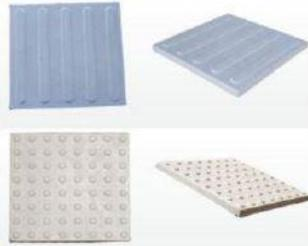
Piso Tátil/Podotátil de Concreto (Cimento e areia) em placas. Modelos: Alerta e Direcional, sendo que o piso tátil direcional consistem em um conjunto de relevos lineares e o piso tátil alerta consiste em relevos de seção tronco-cônica (círculos) sobre a placa. É uma opção de sinalização podotátil para a área externa. Auxilia o deficiente visual e a pessoa de baixa visão a se locomover com maior autonomia por calçadas, parques e pátios.
